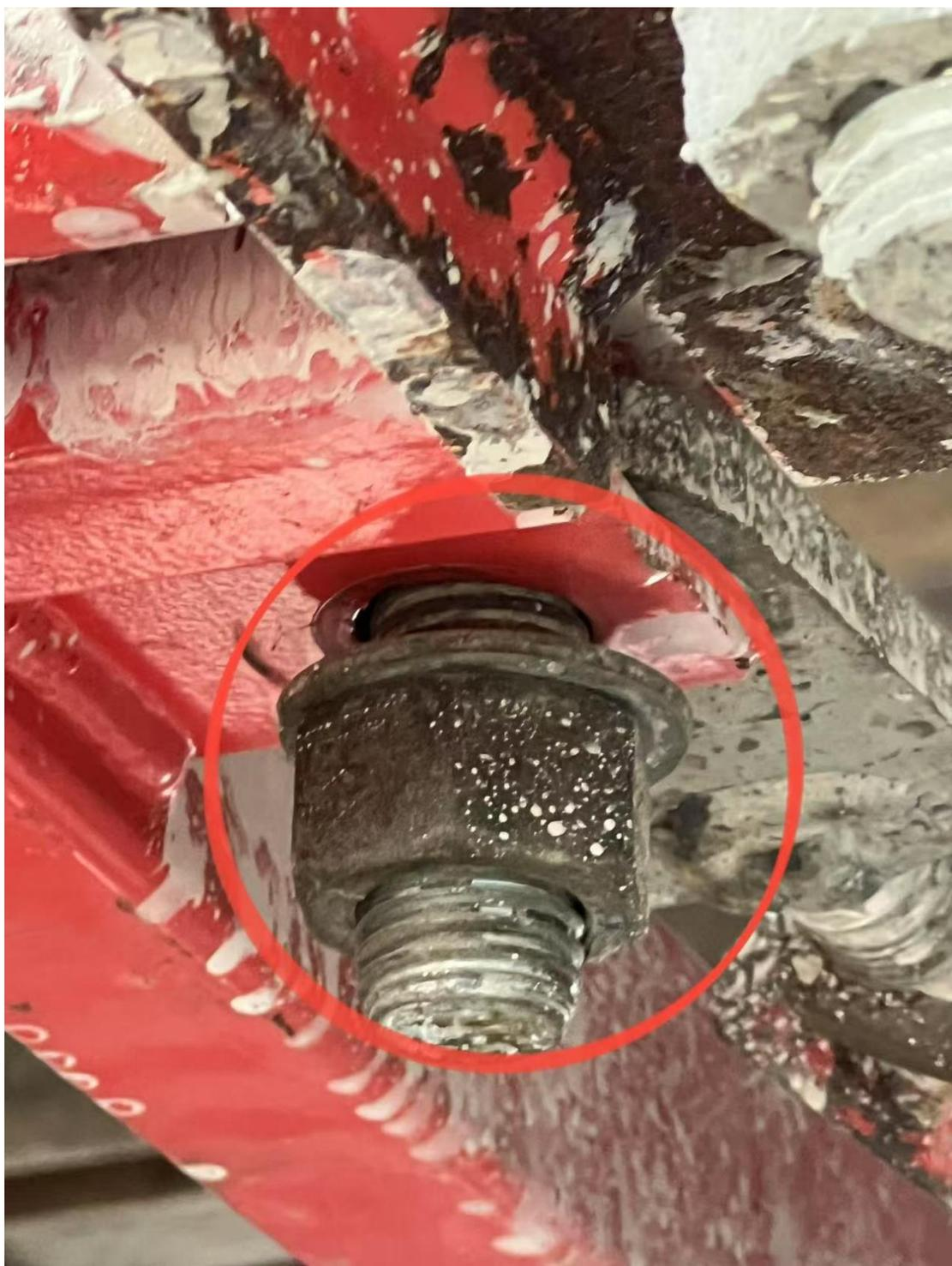
施工升降机附墙螺栓松动
