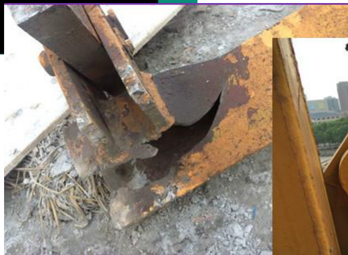
4、爬爪座开裂倒塔 两种设计方式对比
