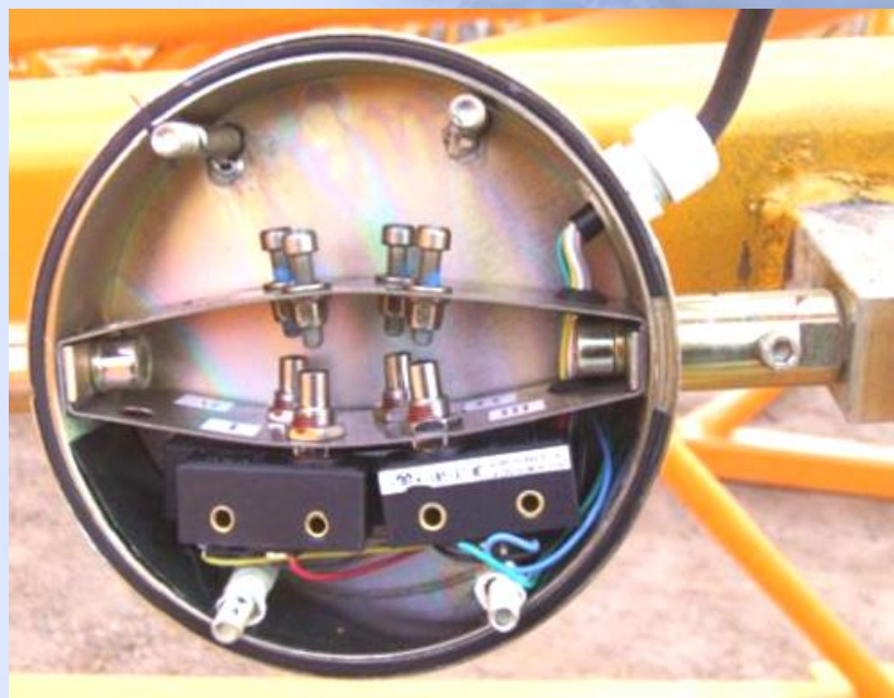
重量和力矩限制器的内部构造
